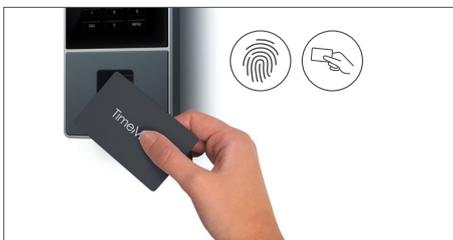
以指纹, RFID感应卡, 感应匙扣, 及密码考勤
