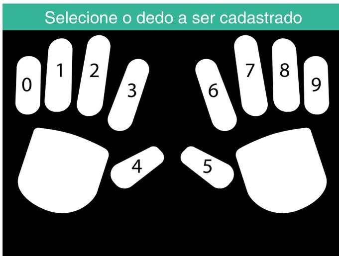
8. Peça ao Utilizador para colocar a ponta do dedo selecionado sobre o sensor, com a unha virada na direção oposta. Dedos recomendados: indicador, médio e anelar.
