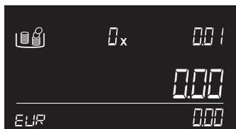
A 6185 irá reiniciar. Após o reinício, o dispositivo irá iniciar-se no modo de contagem, exibindo a primeira designação de moeda a ser contada.
