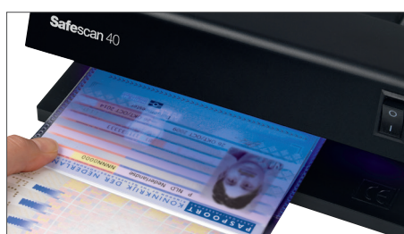
Verifica le caratteristiche UV dei passaporti e di altri documenti d'identità
