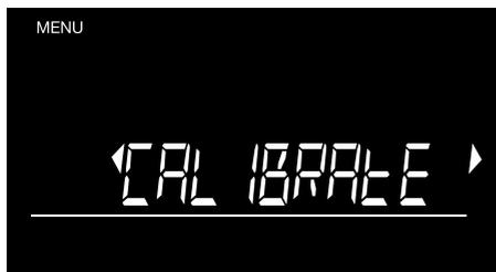
Safescan 6175 は、コインや紙幣の他に、コインロール、コインバッグ、紙幣束、非現金アイテムを数えることができ、2 つ目のコインカップを認識できます。ただし、これらの項目は、最初に校正を行う必要があります。校正モードに入るには、**[校正]** 画面が表示されているときに **[OK]** を押します。校正モードでは、(◀▶) ボタンを使用して目的の通貨単位に移動します。次の校正項目に切り替える場合は、**[メニュー]** を押します。コインロール→紙幣束→パウチャー→トークン→2 つ目のコインカップの順で並んでいます。
