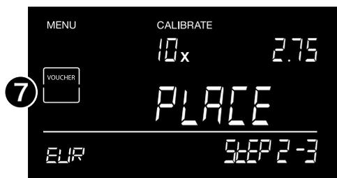
バウチャーを 10 枚、台の上に置きます。バウチャーの計量が終わると、装置は [ピッ] と音を立てます。[OK] を押して確定します。
