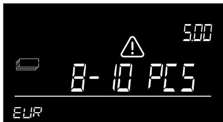
台に置かれた紙幣が多すぎます。[削除 ...-... 個] と表示されます。6175 が紙幣の量を判断できるまで、提案された枚数の紙幣だけを取り出します。小バッチで台の上に紙幣を追加し続けます。
