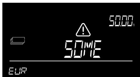
不適切な重量を検出: 6175 は、台の上の紙幣の適切な量を決定できません。[一部削除] と表示されます。6175 が紙幣の量を判断できるまで、数枚の紙幣を取り出します（一度に最大5枚まで）。小バッチで台の上に紙幣を追加し続けます。
