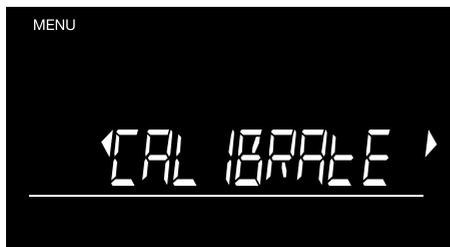
Safescan 6165 还可以清点硬币卷/袋、纸币捆和第二个硬币杯。这些必须首先在 6165 上进行校准。要进入校准模式，请在显示“**CURRENCY**”屏幕时按“**OK**”。在校准模式下，使用(◀▶)按钮导航到所需的面额。如果要切换到下一个校准物品，按“**OK**”。切换顺序是：硬币卷 - 纸币捆 - 硬币杯。
