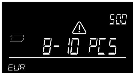
在滑钞板上放置的纸币过多。显示屏显示“取出...张”。在 6165 能够确定纸币金额之前，按照建议取出尽可能多的纸币。继续在滑钞板上少量添加更多纸币。
