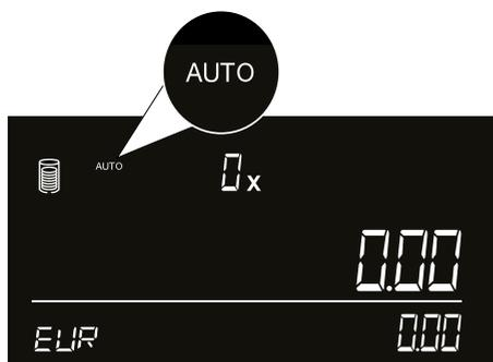
自动硬币卷识别将在清点散钞后直接启动。屏幕上会显示“**AUTO**”图标。
