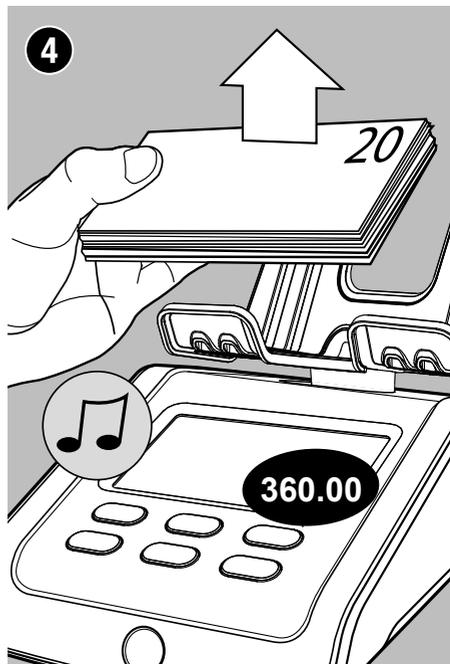
同时取出滑钞板上的所有纸币。您会听到“哗”的一声，确认纸币已清点完毕。它们的价值将被添加到总计。6165 将自动切换到下一个纸币面额。
