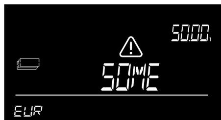
检测到不合逻辑的重量：6165 无法确定滑钞板上纸币的正确金额。显示屏显示“取出一些”。取出几张纸币（一次最多 5 张），直到 6165 能够确定纸币的金额。继续在滑钞板上少量添加更多纸币。
