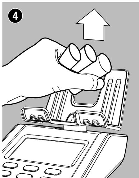
Retire todos os rolos de moedas da plataforma de dinheiro. O resultado da contagem será adicionado ao total. O dispositivo mudará automaticamente para a próxima denominação do rolo de moedas.
