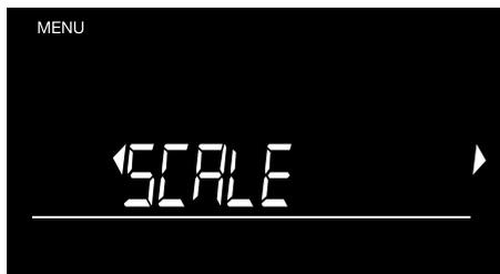
Para activar a função da balança, prima **"OK"** .
