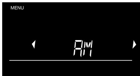
Alternar entre AM e PM, utilizando (◀▶), e prima **"OK"** para confirmar.
