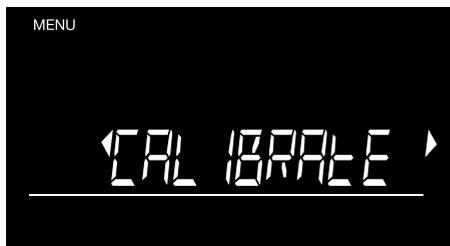
O Safescan 6165 também é capaz de contar rolos/sacos de moedas, maços de notas e um segundo copo de moedas. Estes têm primeiro de ser calibrados no 6165. Para entrar no modo de calibração, prima "OK" quando a "MOEDA" aparecer no ecrã. No modo de calibração, utilize os botões (◀▶) para navegar até à denominação desejada. Se quiser mudar para o próximo item de calibração, prima "OK". A sequência é Rolos de Moedas - Pacotes de Notas - Copo de Moedas.
