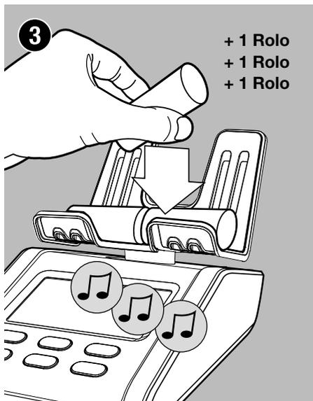
Adicione outro rolo de moedas da denominação seleccionada na plataforma e aguarde pelo som do bip de confirmação antes de adicionar o próximo rolo de moedas. Repita este processo, adicionando rolos de moedas um a um até todos os rolos de moedas desta denominação estarem na plataforma e contados.
