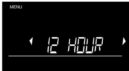
Alterne entre o formato de 12 horas e 24 horas, utilizando (◀▶), e prima **"OK"** para confirmar.
