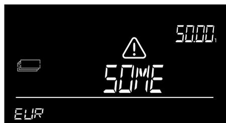
Peso ilógico detectado: o 6165 não é capaz de determinar a quantidade correcta de notas na plataforma. O visor indica "**Remover algumas**". Remova algumas notas (máx. 5 notas de cada vez) até o 6165 ser capaz de determinar a quantidade de notas. Continuar a adicionar mais notas na plataforma em pequenos lotes.
