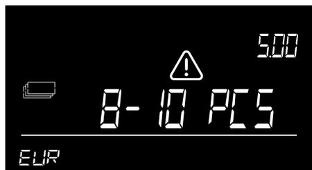
Foram colocadas demasiadas notas na plataforma. O visor indica "**Remover ...-... pcs**". Remova o número de notas sugeridas até o 6165 ser capaz de determinar a quantidade de notas. Continuar a adicionar mais notas na plataforma em pequenos lotes.
