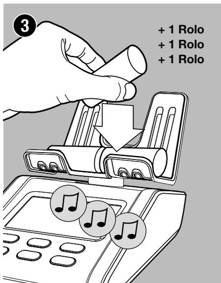
Adicione outro rolo de moedas na plataforma e aguarde pelo som de aviso sonoro de confirmação antes de adicionar o próximo rolo de moedas. Repita este processo, adicionando rolos de moedas um a um, até todos os rolos de moedas estarem na plataforma e contados.
