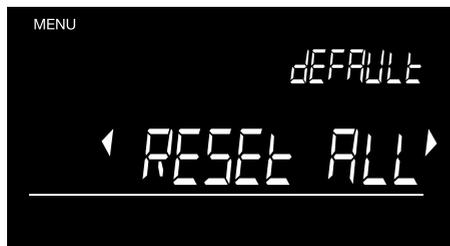
Prima **"OK"** para começar a reiniciar a máquina. Se quiser recomeçar de novo com o seu Safescan 6165, pode repor as predefinições de fábrica do dispositivo. Predefinição: Repor as predefinições, mantendo as calibrações dos pacotes de moedas do utilizador. Predefinição **'Todos Cal'**: Repor as definições por defeito, incluindo as calibrações dos utilizadores dos pacotes de moedas.
