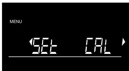
Se, devido a uma sobrecarga ou impacto na plataforma de dinheiro, a função da célula de carga 6165 (elemento de pesagem) for danificada, uma recalibração da célula de carga pode ajudar a recuperar a função.
