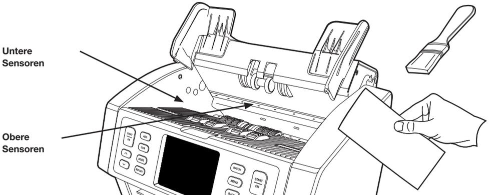
2. Ziehen Sie die Rückwand vollständig heraus und reinigen Sie sie nach Anweisung. Die Innenseite der Maschine ebenfalls reinigen. Wenn Sie fertig sind, müssen Sie die Platten in umgekehrter Reihenfolge anbringen: Rückwand > Obere Platte.
