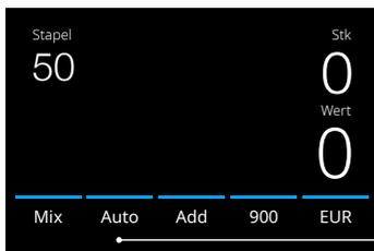
Wenn die Einstellung „Auto“ aktiviert ist, beginnt das Gerät automatisch mit der Zählung, wenn die Banknoten auf den Trichter gelegt werden. Wenn Auto deaktiviert ist, muss die Taste **[START/OK]** gedrückt werden, um mit dem Zählen zu beginnen.
