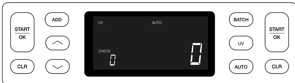
Safescan 2250: Drücken Sie die **START**-Taste für 3 Sekunden zur Aktivierung/Deaktivierung der Autostart-Funktion.
