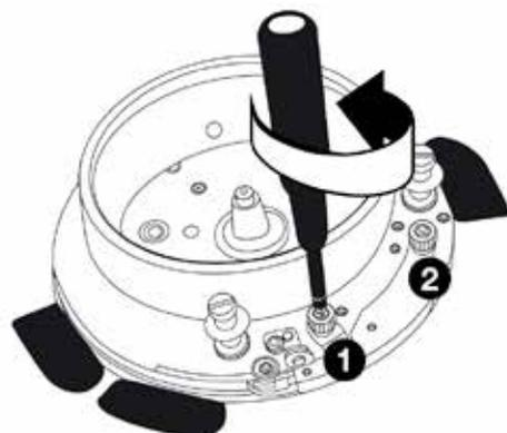
7. Benutzen Sie einen Schraubenzieher, um die mit 1 und 2 gekennzeichneten Schrauben zu entfernen.
