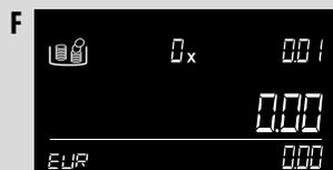
Von nun an werden Sie, sobald der Safescan 6165 gestartet wird, danach gefragt, welcher Becher als Präferenz eingestellt werden soll: der Becher, der als Standard mit dem Gerät geliefert wird (**CUP 1**), oder einer, der kalibriert wurde (**CUP 2**). Verwenden Sie die Tasten, um den gewünschten Becher auszuwählen. Die Auswahl wird automatisch gespeichert.
