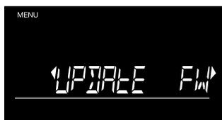
Drücken Sie  um das Gerät in den Firmware-Update-Modus zu versetzen.
