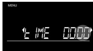
Die MINUTENANZEIGE blinkt jetzt. **Kurz drücken auf ▶**, um 1 Min nach oben oder unten zu gehen, und **lange drücken** um durch die Minuten zu laufen. Drücken Sie **OK** zur Bestätigung.
