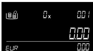
Beim Neustart der 6165 Geldwaage startet das Gerät den Zählmodus und zeigt den ersten Münznennwert an, der gezählt werden soll.
