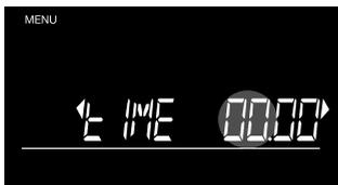
Die STUNDENANZEIGE blinkt jetzt. **Kurz drücken auf ▶**, um 1 Stunde nach oben oder unten zu gehen, **lange drücken** um durch die Stunden zu laufen. Drücken Sie **OK** zur Bestätigung.
