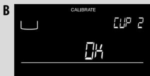
Die Maschine wird nun anzeigen, dass das Gewicht des Bechers verarbeitet worden ist.
