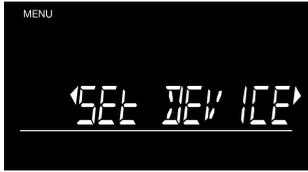
Wenn der Bildschirm **SET DEVICE** angezeigt wird, können Sie verschiedene Geräteeinstellungen ändern. Drücken Sie **OK**, um zu diesem Menüpunkt zu gelangen. Im SET DEVICE Modus (GERÄT EINSTELLEN), verwenden Sie die **◀ ▶** Tasten, um durch die Unterpunkte zu navigieren.
