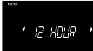
Wechseln Sie zwischen dem 12 Stunden und 24 Stunden Format unter Verwendung von **◀ ▶** und drücken Sie **OK** zum Bestätigen.
