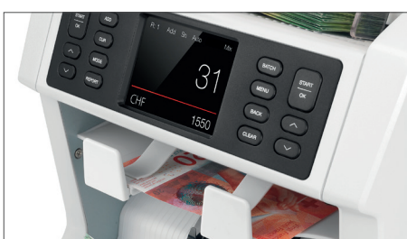
Als Falschgeld identifizierte Banknoten werden im Auswurfach ausgegeben
