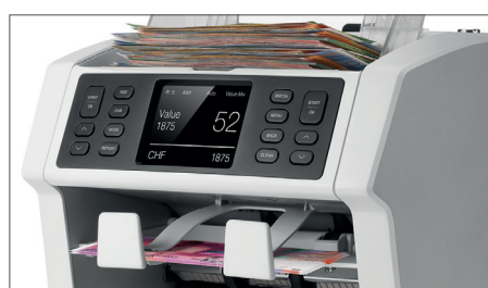
Modus Value-mix: Zählung von Banknoten in Bündelungen eines voreingestellten Werts
