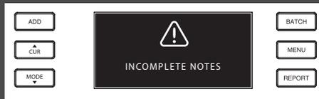
Unvollständige oder beschädigte Banknote. Kann auftreten, wenn eine eingerissene Banknote in die Maschine eingespeist wird. Nehmen Sie die Banknote heraus und überprüfen Sie sie und drücken Sie **START** zum Fortsetzen.
