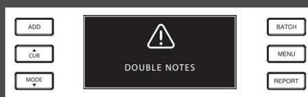
Manchmal bleiben Banknoten stecken oder sind zusammengefallen. Prüfen Sie die Banknoten und zählen Sie erneut. Wenn diese Fehlermeldung öfter auftritt, verändern Sie das Trichterstellrad leicht (+).
