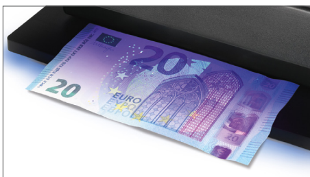
Prüft die UV-Merkmale von Banknoten
